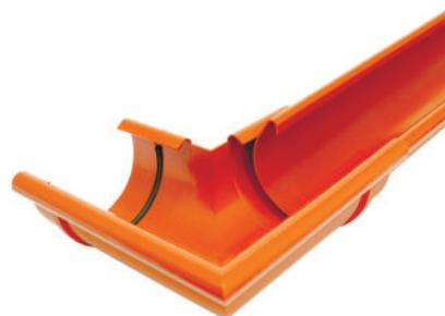
Угловые элементы и муфту желоба соединяем с желобом вдавливая передний закругленный выступ желоба в муфту, а дальше заднюю часть желоба защелкиваем. Края желоба должны находиться **около 5 мм перед ограничителями.**
