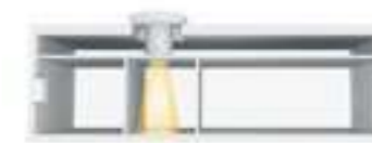
Застосування світлового тунелю для плоских дахів
