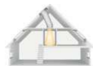
Застосування світлового тунелю для похилих дахів
